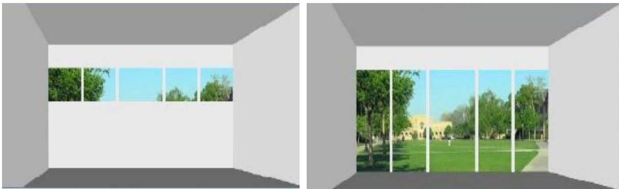
Figure 52 : Les ouvertures horizontales
