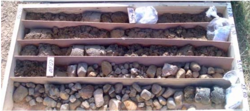
Photo 7 : aspect général des alluvions
