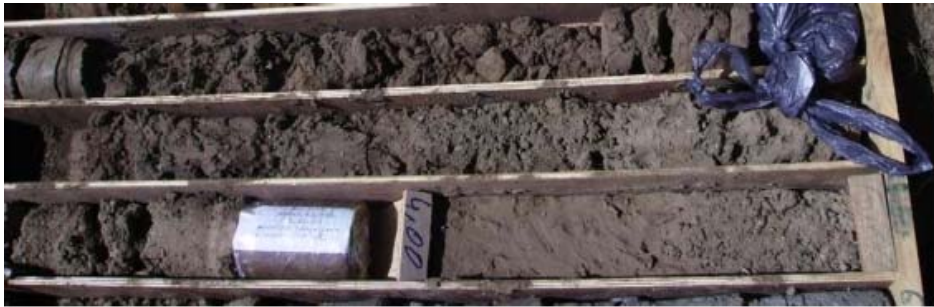
Photo 10 : aspect en sondage des argiles sablonneuses
