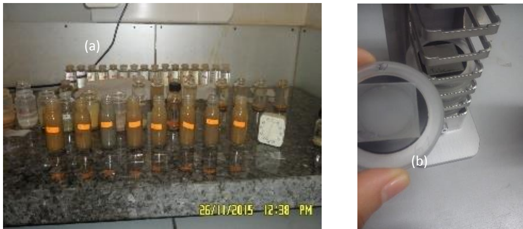
Fig. 31 : Etapes de préparation des fractions argileuses pour analyse par DRX Séchage à l'air libre (N) ; a : loi de Stokes et méthode de Moore et Reynolds, b : emplacement des lames pour analyse
