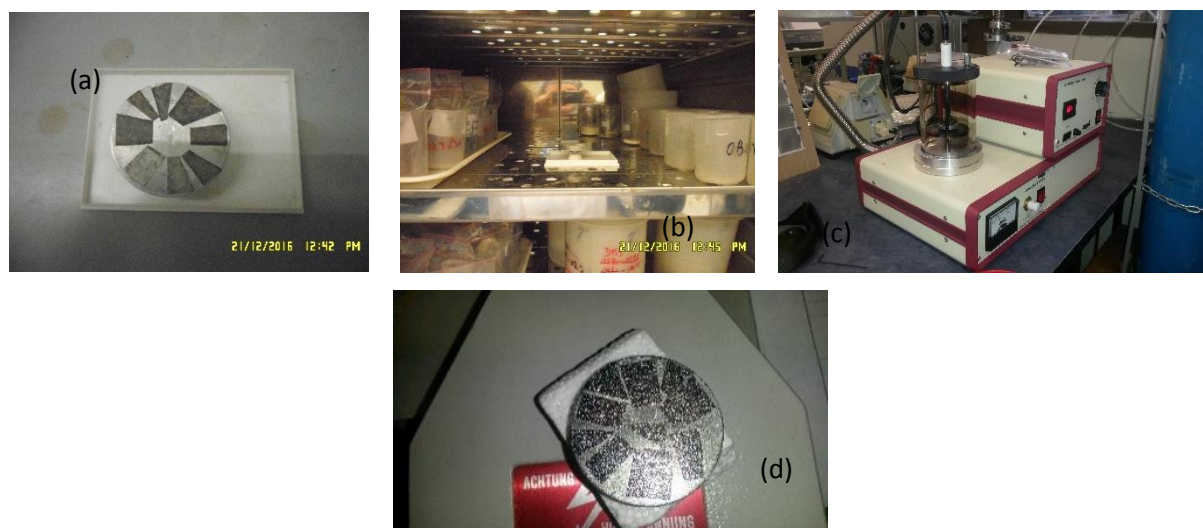
Fig. 36 : Métallisation des poudres à carbone par pulvérisation plasma : a : emplacement d'échantillons, b : chauffé, c et d : après métallisation des poudres à carbone par pulvérisation plasma
