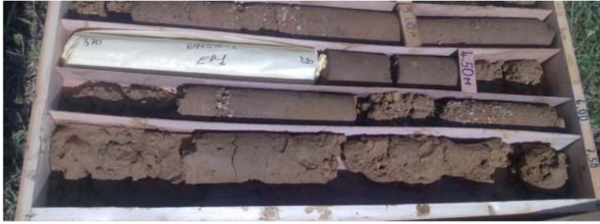
Photo 9 : aspect en sondage des argiles alluvionnaires
