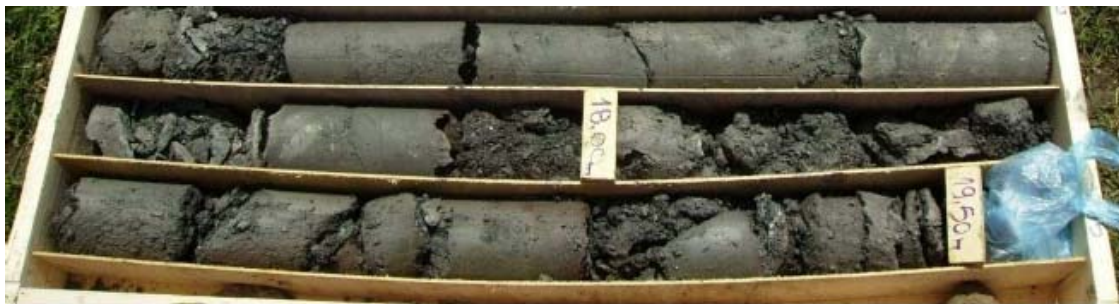
Photo 3 : Aspect des formations argileuses sous numidiennes (prof. entre 17 et 20 m)
