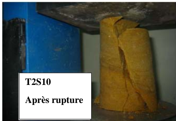
Photo : essai bi axial (échantillon avant rupture) Photo : essai bi axial (échantillon après rupture)
