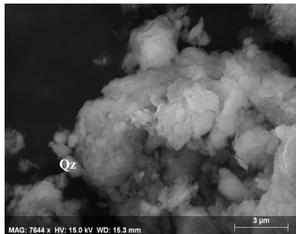
Photo : photo MEB de l'échantillon prélevé du tunne2 Guessaba sondage 13 (T2S13)
