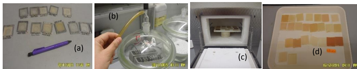
Fig. 32 : Etapes de préparation des fractions argileuses pour analyse par DRX Saturation à l'éthylène glycol (EG) ; (a, b) : emplacement et saturation pendant 24 h, chauffage à 500°C (H) (c, d) : chauffage dans un four pendant 4 heures.
