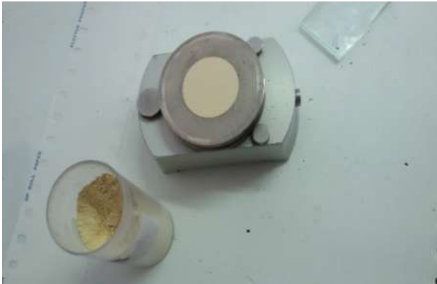
Figure F. Préparation de l'échantillon de grès pour analyse par DRX
