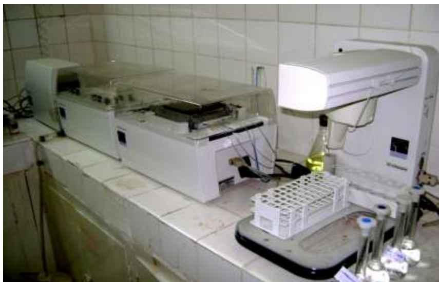
Figure 19. Auto-Analyseur-Technicon Type III (Laboratoire d'Analyse et de Caractérisation, Entreprise de phosphate Djebel Onk – Tébessa)
