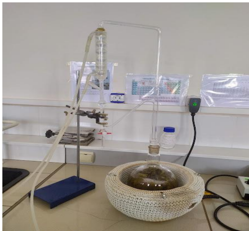
Figure 6. Appareil utilisé pour l'hydro-distillation (Photographie personnelle).
