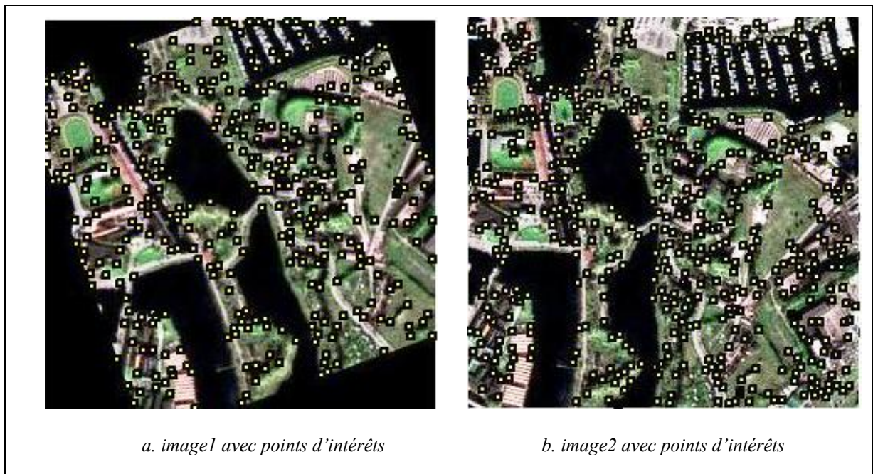
Figure V-7 : points d'intérêt extraits par le détecteur SIFT
