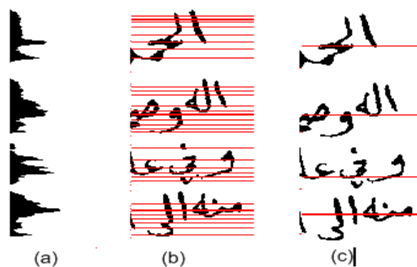
Figure 3.10: (a) Histogramme des projections horizontales d’une colonne, (b) détection des pics, (c) filtrage des pics
