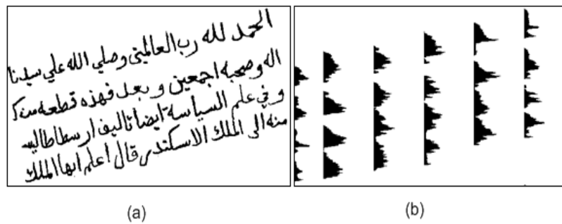
Figure 3.9: (a) Image inclinée, (b) histogrammes des projections de chaque colonne
