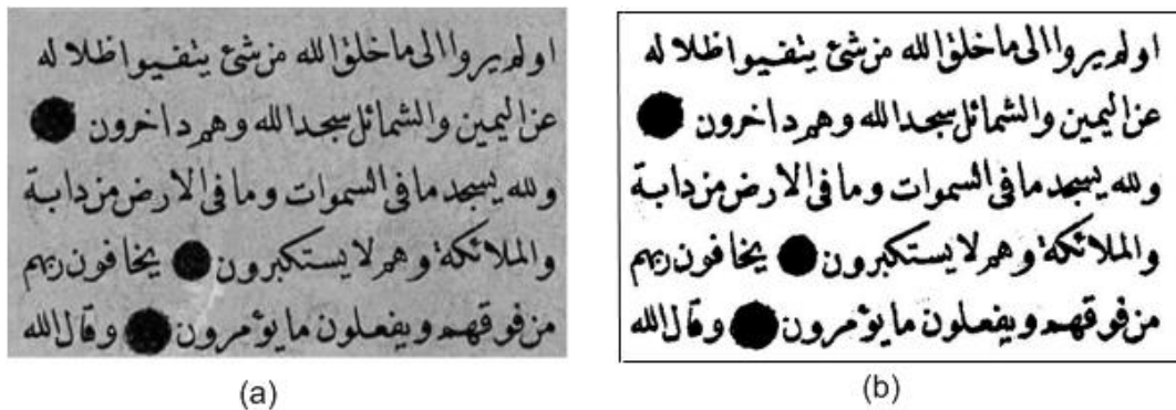
Figure 3.6: Binarisation d'une image de document, (a) image en niveaux de gris, (b) image binaire
