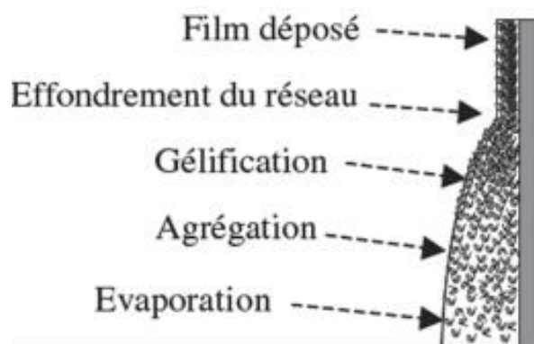
Figure III.4. Schématisation de la couche déposée après trempage [126].
