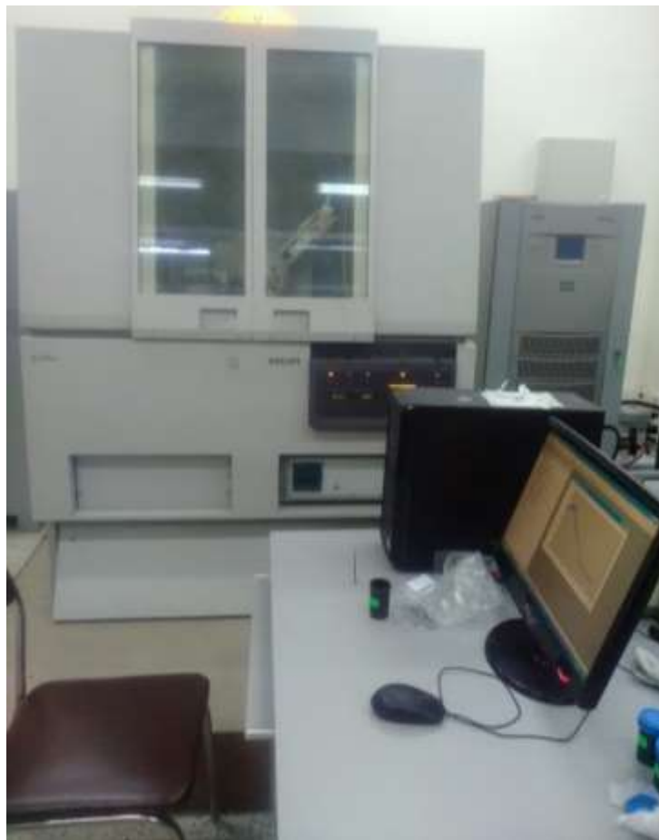
Figure II.9 : Diffractomètre Philips X'Pert équipé du rayonnement Cu- K\alpha ( \lambda = 1\,5418 \text{ \AA} ).
