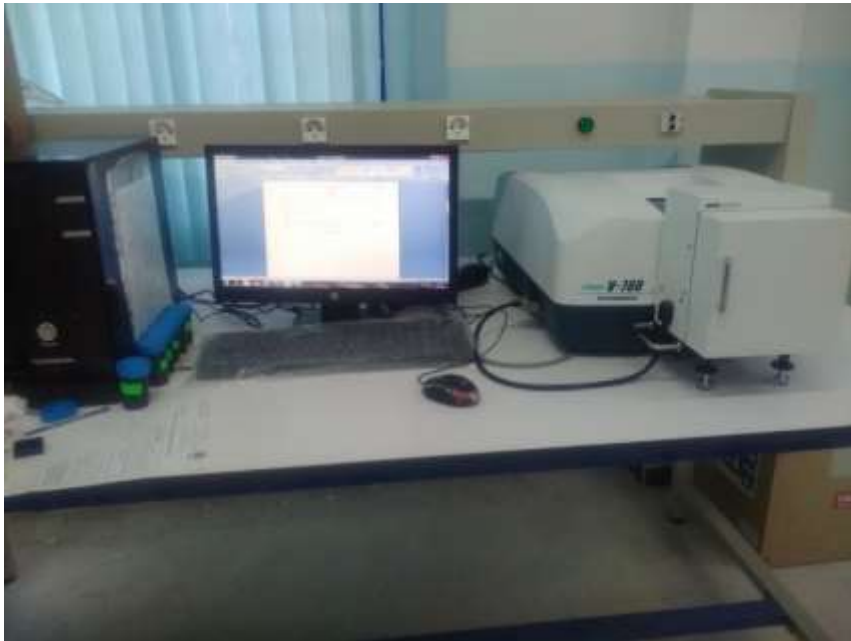
Figure II.12 : Spectrophotomètre JASCO V-760 UV- visible utilisable dans la région spectrale UV-Vis-NIR (200-800 ) nm
