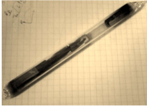
Figure II. 4. Photo montrant des échantillons Al-Mn introduits dans un tube de quartz.
