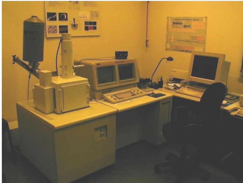
Figure II. 6. Microscope Electronique à Balayage à effet de champ (MEB Quanta 200 ESEM/FEG. Philips) (LREMPS-UTBM).
