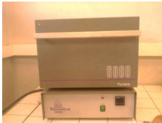
Figure II. 5. Four de traitement thermique électrique type Thermolyne 6000 (LEREC).
