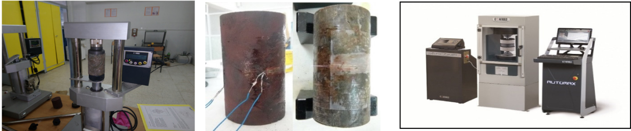
Figure IV.2. Échantillon de massif rocheux avec jauges de contrainte.
