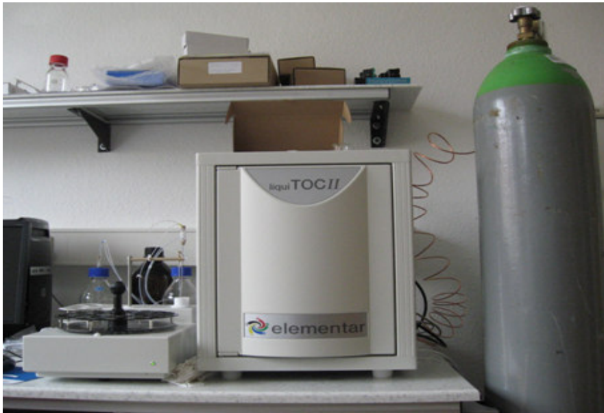
Figure IV-4 : Photographie de l'analyseur de COT Elementar LiquiTOC II
