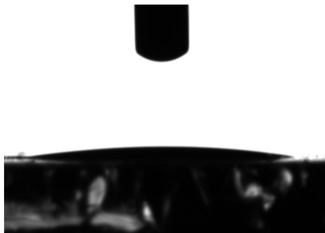
Figure III.2.17: Angle de contact de l'eau sur le film nanostructuré de ZnO.
