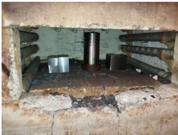
Fig III.4 quatre échantillons dans un four THERMIDOR.
