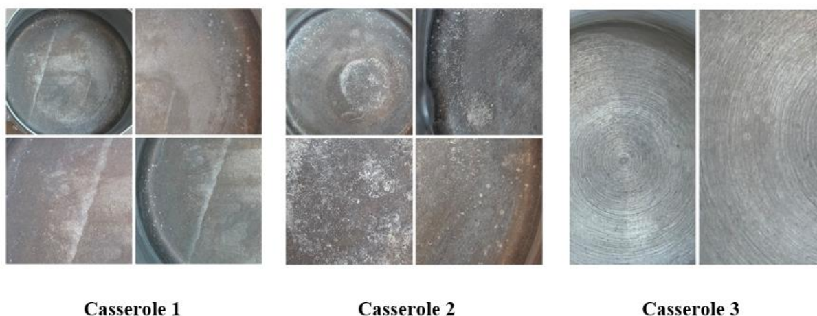
Figure 114. Effets de l'ébullition sur la surface des casseroles en aluminium.
