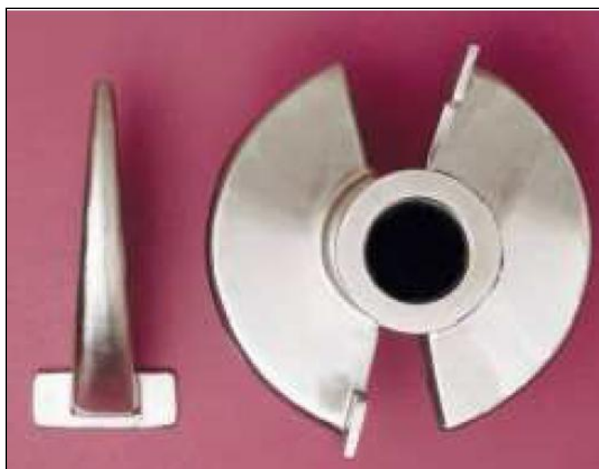
Figure N°15 : Palettes du séchoir à pales [66]
