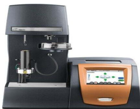
Figure. III. 13: Principe et appareillage d'un analyseur thermogravimétrique, modèle TGA 550-ta [31].
