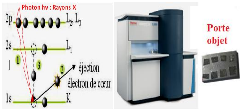
Figure. III. 12: Principe de la spectrométrie photo électronique par Rayons- X et la photo de l'appareillage utilisé [27].
