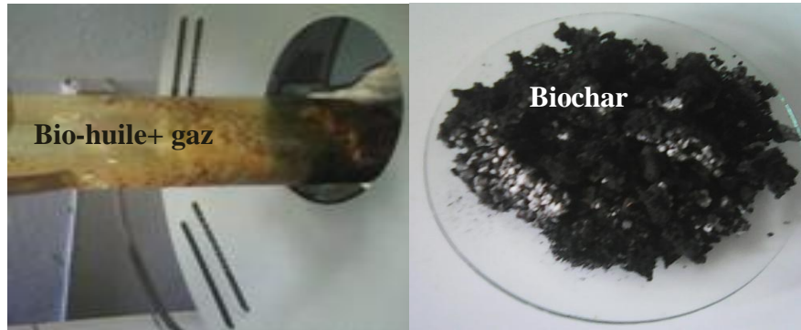
Figure. IV. 1: Les produits de la pyrolyse (a) bio huile et gaz dans u réacteur en quartz, (b) Biochar.
