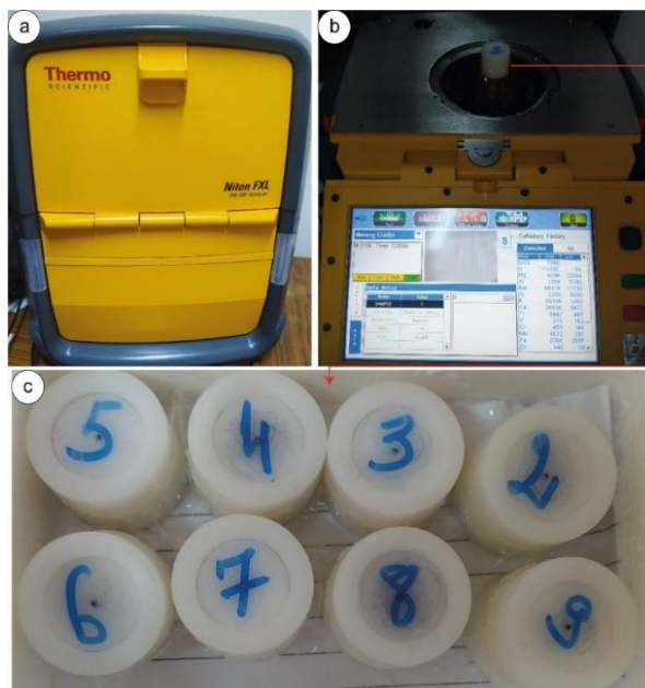
Fig. 66. Appareil de spectrométrie par fluorescence X (XRF) utilisé et le principe de fonctionnement de la méthode d'analyse.
