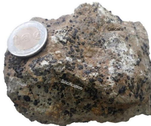
Fig. 59. Macrophotographie montre le processus de silicification affectant les calcaires de Mesloulou.
