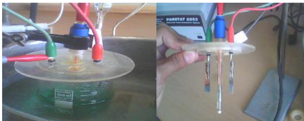
Figure II.8 : Les trois électrodes utilisées dans la cellule électrochimique (une lame de nickel considérée comme anode branchée au fil rouge (CE), une lame de cuivre considérée comme cathode branchée au fil vert (ET) et une électrode de référence au calomel KCl saturé avec E_0 = 244 \text{ mV} ).
