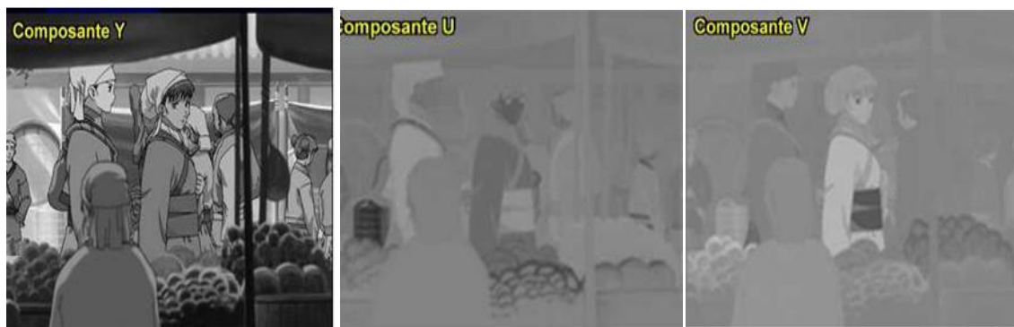
Figure I.3. Décomposition de l'image I.2 en composantes: luminance(Y) et chrominance (U et V)
