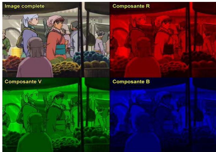
Figure I.2. Décomposition de l'image en composantes: rouge, vert et bleu
