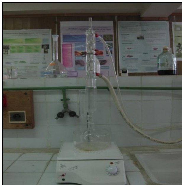
Photo 3 : Dispositif de l'appareil de soxhlet installé au laboratoire
