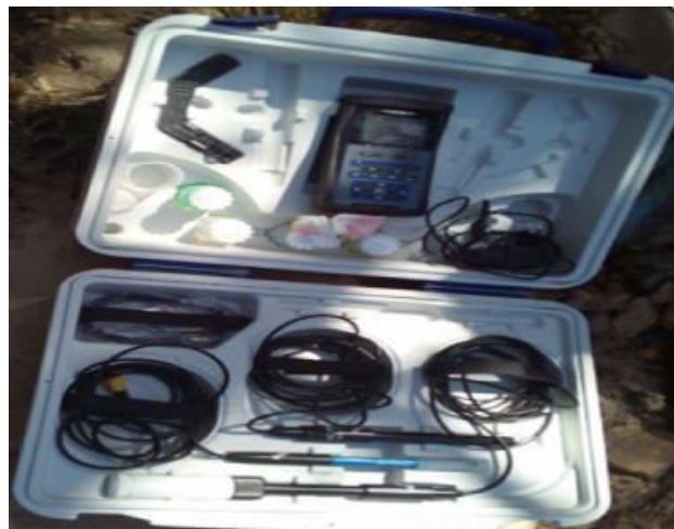
Figure 27. Un multi-paramètre de terrain (WTW: Wissenschaftlich-Technische Workstation GmbH)
