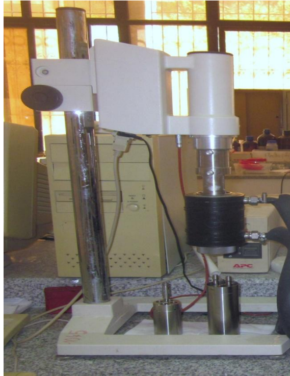
Photos N°4 : Rhéo viscosimètre de marque HAAKE VT 550
