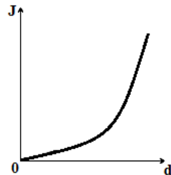
Fig. II.17c Variation de J en fonction du déplacement imposé d, pour des fissures de différentes longueurs, a_1, a_2, a_3 \dots
