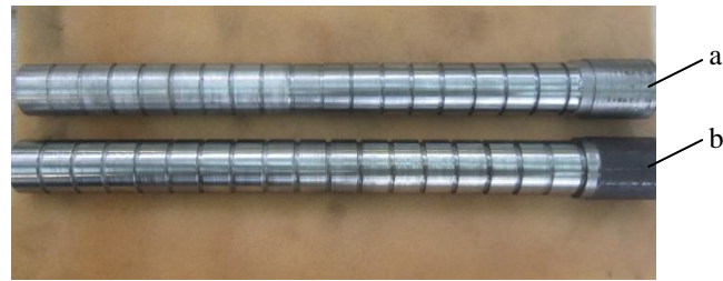
Figure II.6 : Pièces traitées : a-Acier A60 ; b- Acier XC48
