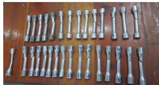
Figure IV.6 Eproutettes d'aluminium a-avant l'essai de traction ; b-après l'essai de traction
