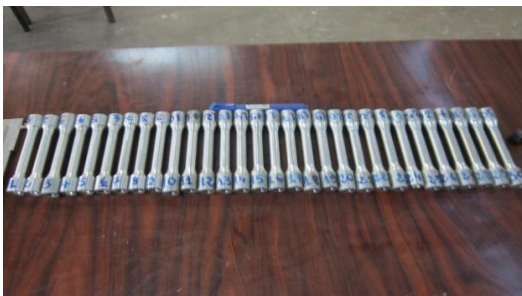
Figure IV.6 Eproutettes d'aluminium a-avant l'essai de traction ; b-après l'essai de traction
