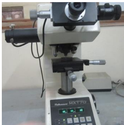
Figure IV.4 Micro-duromètre (Matsuzawa MXT70)
