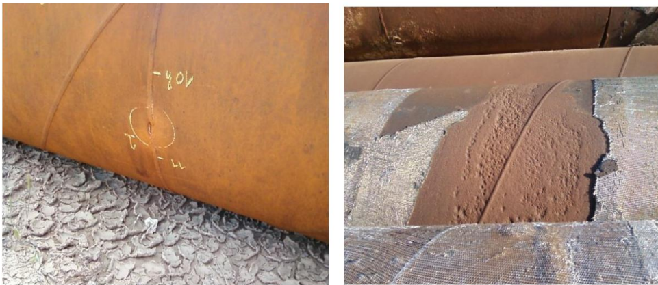
Figure 1.1 : Corrosion d'un pipeline en API X60 de diamètre de 1016mm et épaisseur de 12.7mm
