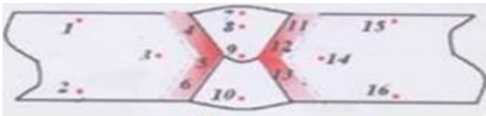
Figure 2.3 : Points de mesure de la dureté au niveau du métal de base (points 1, 2, 3, 14, 15 et 16) de l'acier X70
