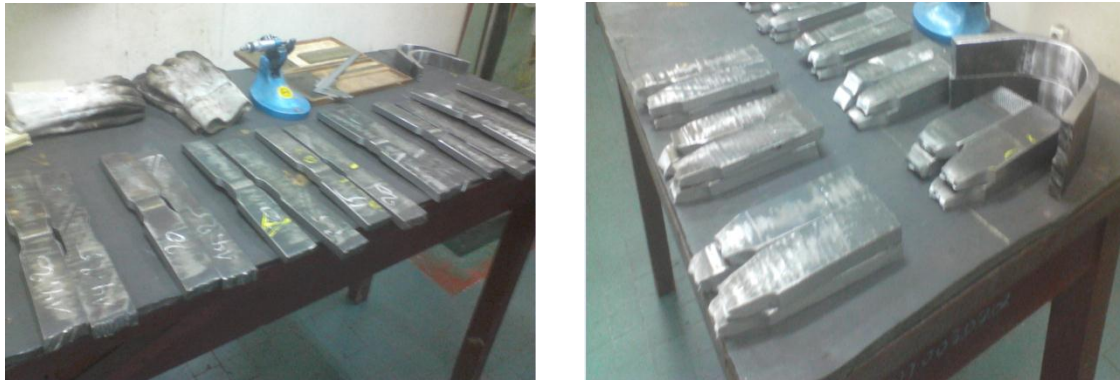
Figure 2.6 Eprouvettes de de traction en acier API X70 (a) avant essais (b) rompues
