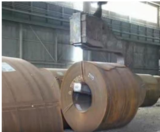
Figure 2.1 : Tôles de bobines en en acier X70 fournit par la compagnie THYSSEN
