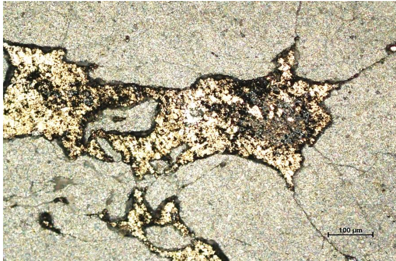
Figure III-10: Micrographie optique de l'alliage Al-40%Co.
