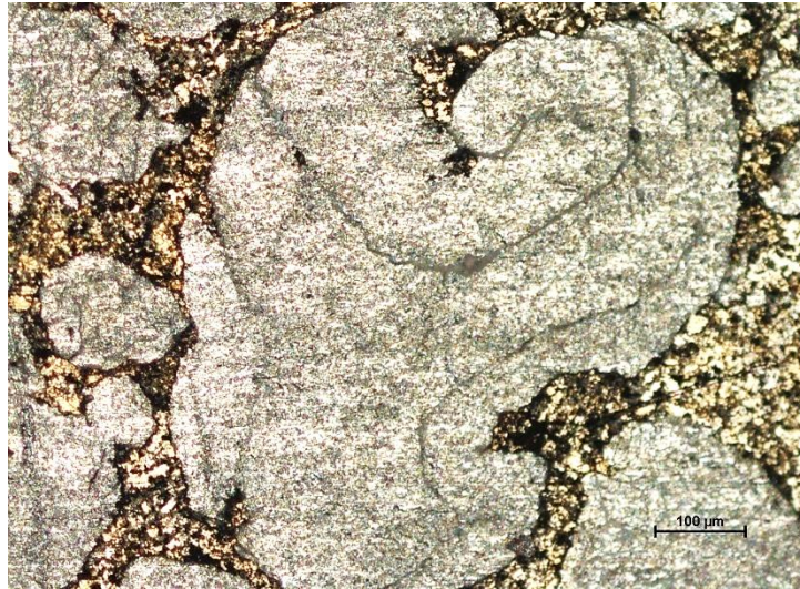
Figure III-8: Micrographie optique de l'alliage Al-20%Co.
