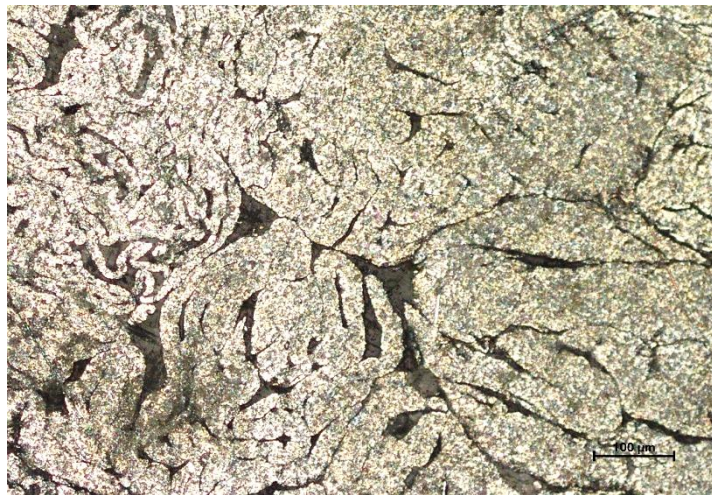
Figure III-7: Micrographie optique de l'alliage Al-10%Co.
