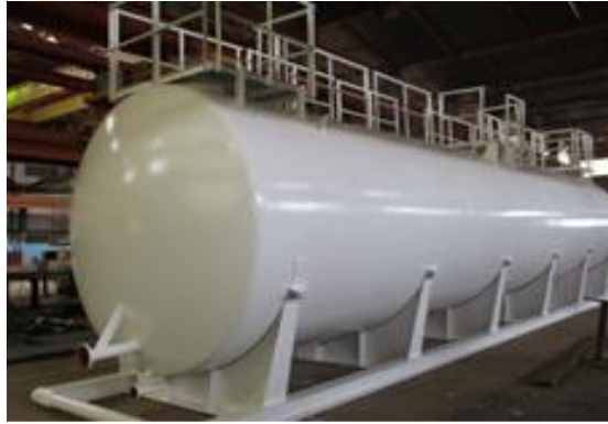
Figure II.2: Cuve 100 m 3 pour stockage de carburant
