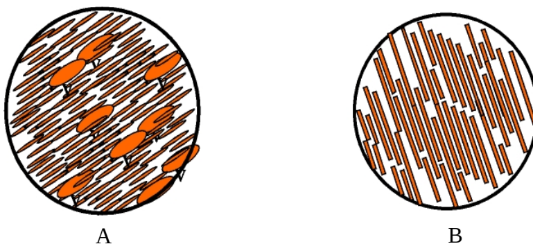
Figure-I-9-Eutectique mixte A- Baguettes, cercles et ellipse B- baguettes, ellipses
