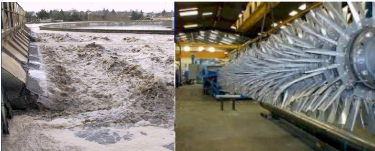
Photo 2 : Aérateur de surface Brosse
