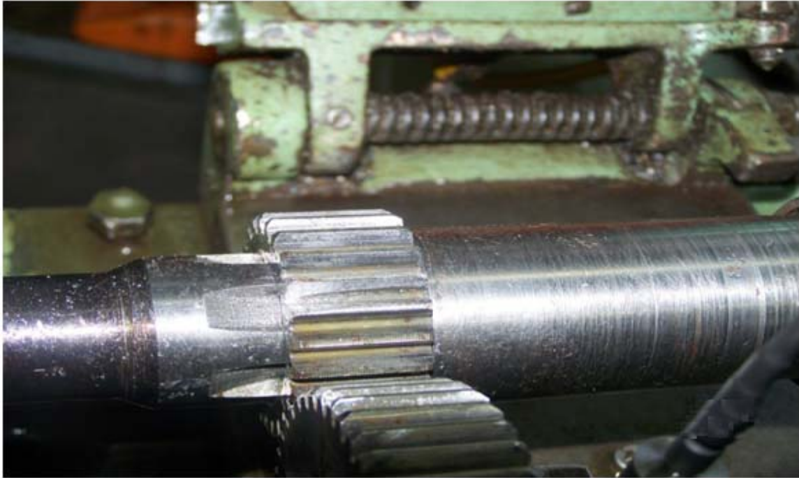
Figure V.9 : L'usure d'une dents
