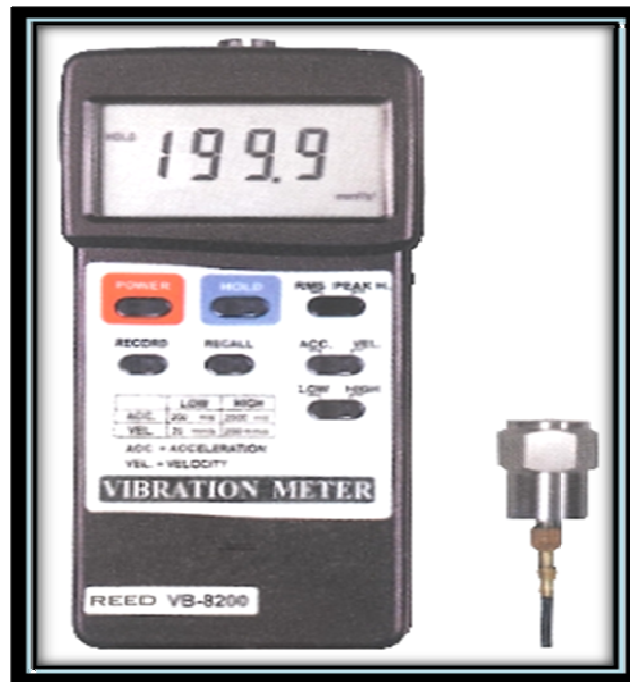
Figure V.10 : Appareil de mesure vibration meter VB-8200
