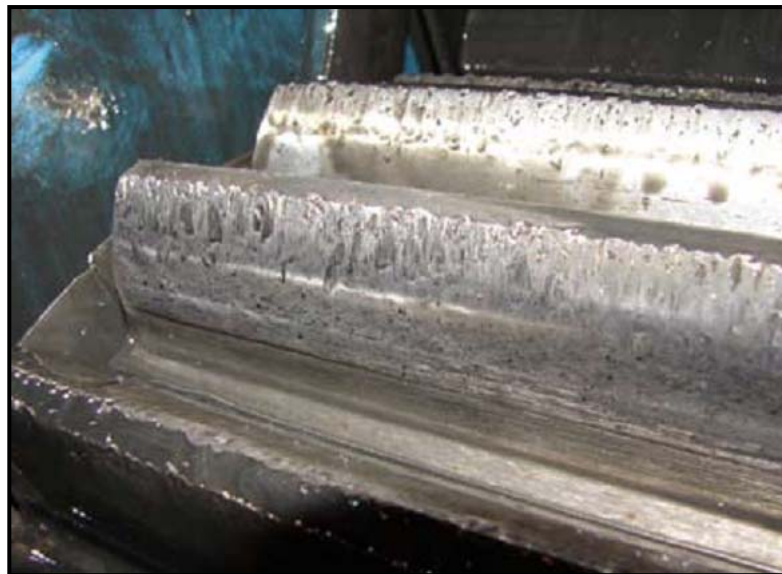
Figure IV.8 : Traces de grippage à froid sur les dents d'une couronne de treuil [21]
