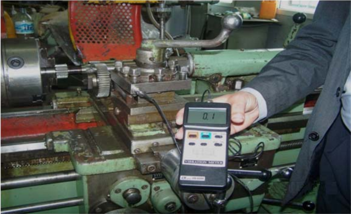
Figure V.7 : Mesure Horizontale par le vibrotest - VB-8200
