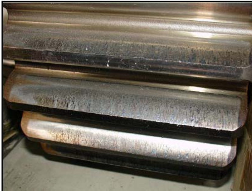
Figure IV.5 : Grippage modéré sur les flancs d'un engrenage cémenté trempé [28]
