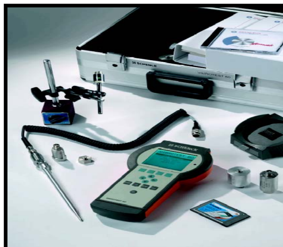
Figure V.12 : les éléments de VIBROTEST 60 avec capteurs de vibration (accéléromètre)
