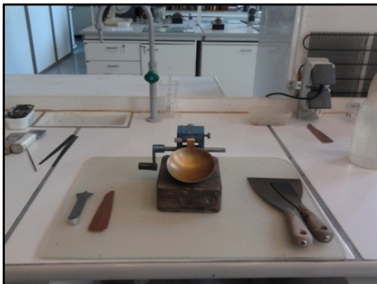
Photo.13. Appareil de Casagrande (calcul de W_L ) Photo.14. Méthode des rouleaux (calcul W_P )
