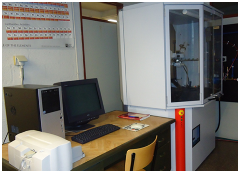
Photo. 07. Photo du diffractomètre de type "Brucker D8-Advance" (AGEs)
