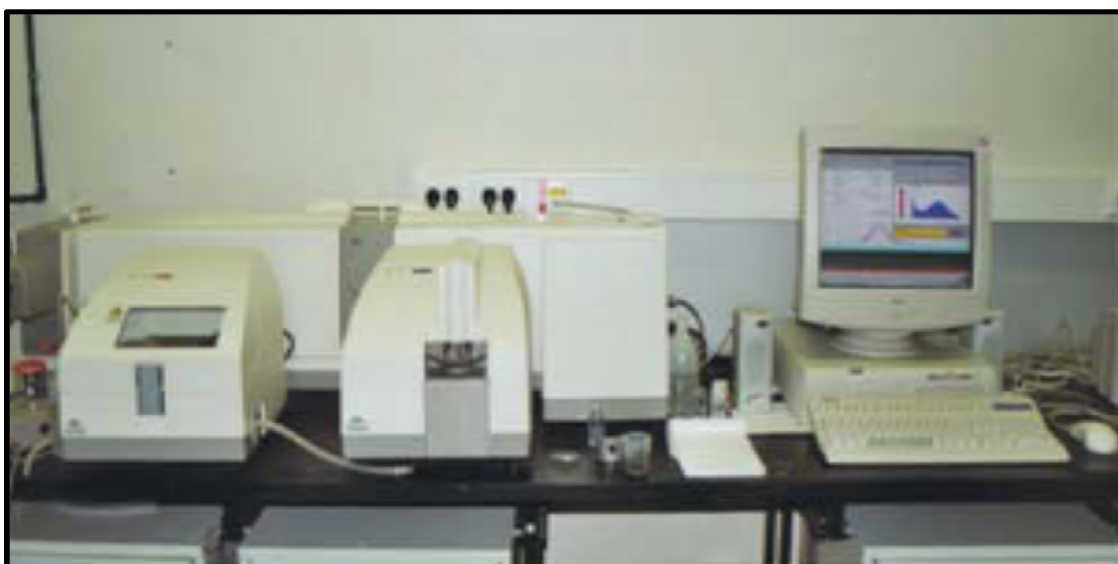
Photo.12. Granulomètre Laser Malven Mastersizer 2000. (Chimie Inorganique et Structurale, Département de Chimie, ULg).
