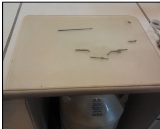
Photo.13. Appareil de Casagrande (calcul de W_L ) Photo.14. Méthode des rouleaux (calcul W_P )
