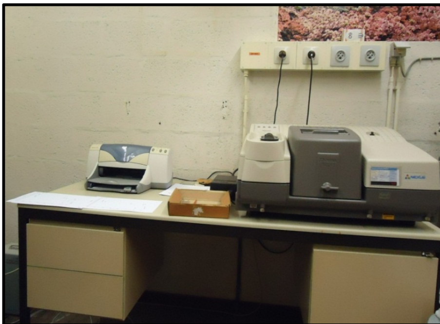
Photo.11. Photo d'un spectromètre infrarouge de type Nicolet NEXUS
