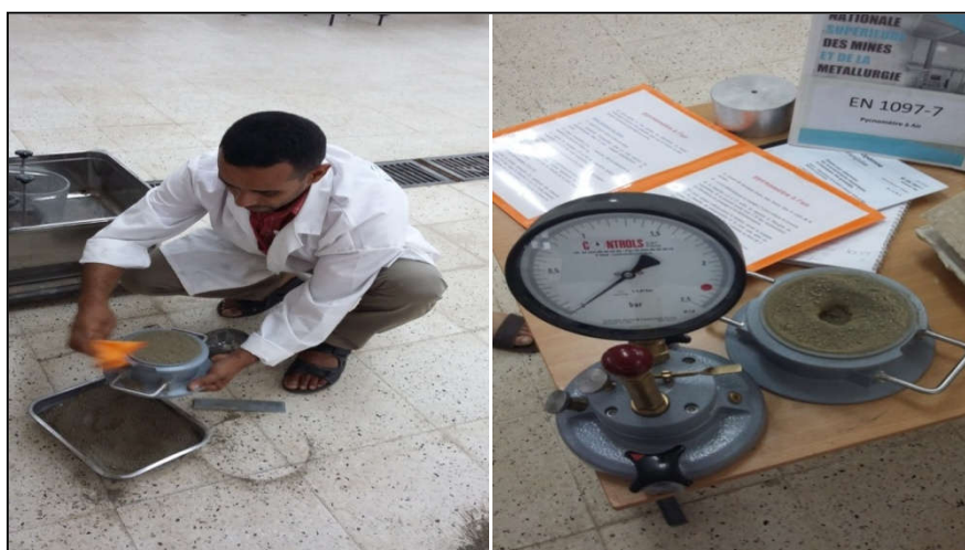
Figure IV.4 Essai des propriétés physiques du sol à l'aide de pycnomètre à l'air (EN1097-7)
