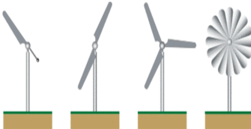
Fig. I.10 : Distinction entre éoliennes à axe horizontal selon le nombre de pales
