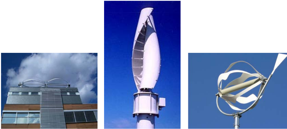
Fig. I.8 : Éolienne de type Darrieus à gauche, Savonius au milieu et Venturi à droite [11].
