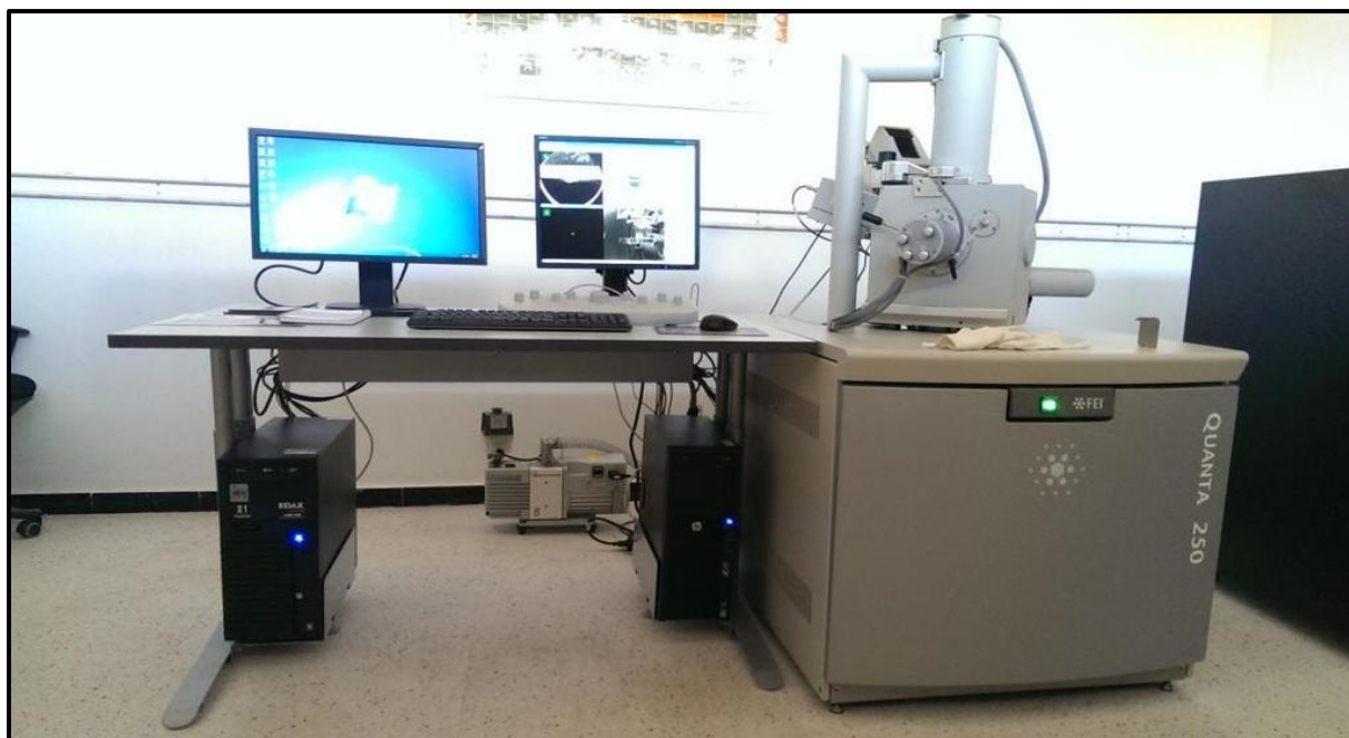
Figure II. 8. Microscopie électronique à balayage MEB de type Quanta 250– FEI équipé d'un détecteur de spectroscopie à dispersion d'énergie (EDS).
