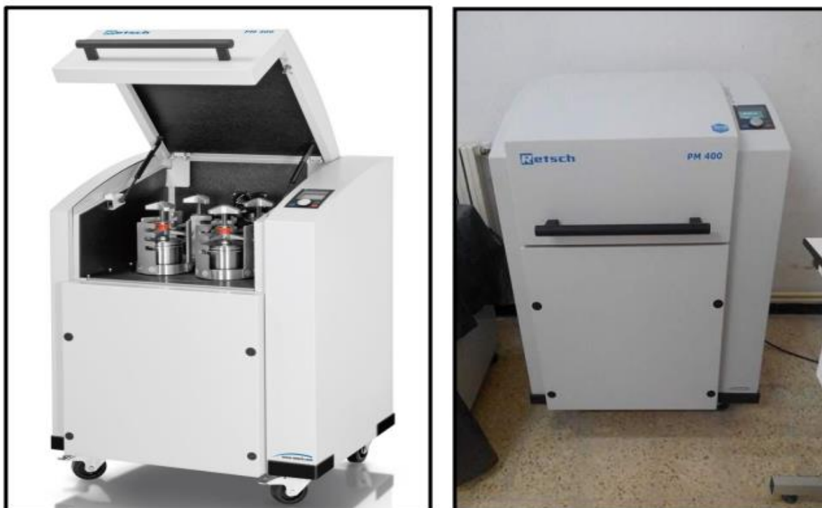
Figure II.2 : Broyeur planétaire, de marque commerciale Retsch PM 400 (modèle Pulvérisette7), utilisé pour la mécanosynthèse des alliages
