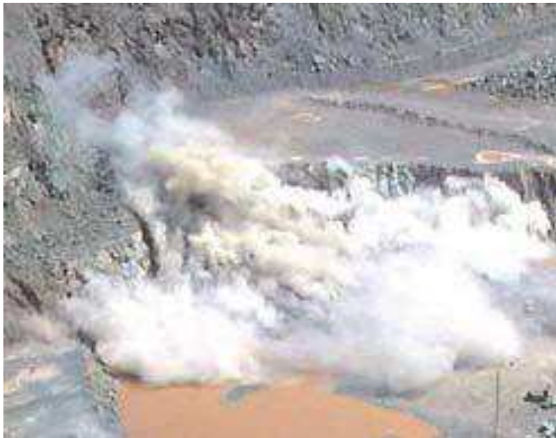
Figure V.6 Nuage de poussières consécutif à un tir de mine.
