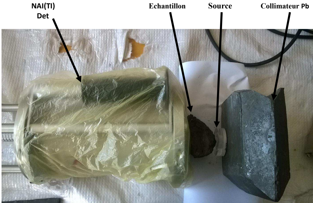
Figure IV.17 Stand expérimental exploité durant les manipulations.
