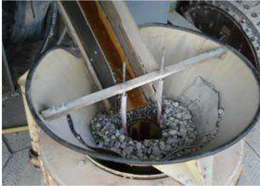
Figure V.8 : Alimentation d'un concasseur.
