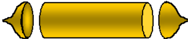
Figure IV.16 : Découpe de l'extrémité du lingot
