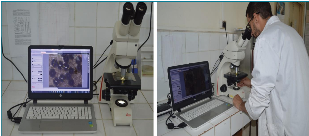
Figure 19 : Microscope optique de type « Leica DM500 » relié à un ordinateur muni d'un logiciel utilisé pour les mensurations du diamètre ovocytaire (Photo personnelle, 2022).
