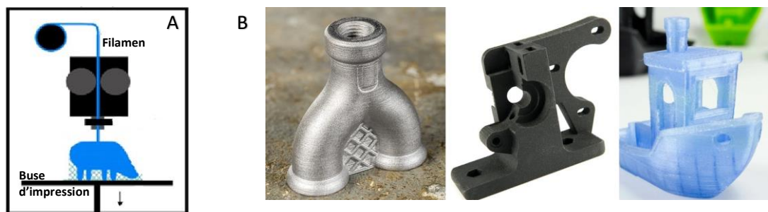
Figure 2.13 : impression 3D par Dépôt de fil fondu. A : Principe de fonctionnement ([Carew2020]). B : des modèles (UltiMaker)
