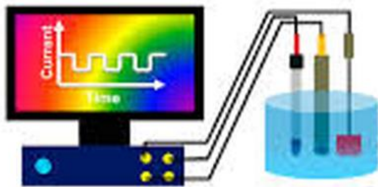
Figure I.10 : Représentation schématique d'un (bio) capteur ampérométrique.
