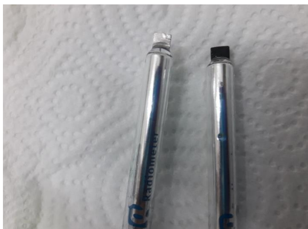
Figure. IV.2. Electrode de travail avant et après l'électro-polymérisation
