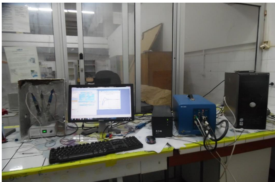
Figure. IV.1. Représentation de la synthèse du composite \beta -Cyclodextrine-polyaniline par polymérisation électrochimique.
