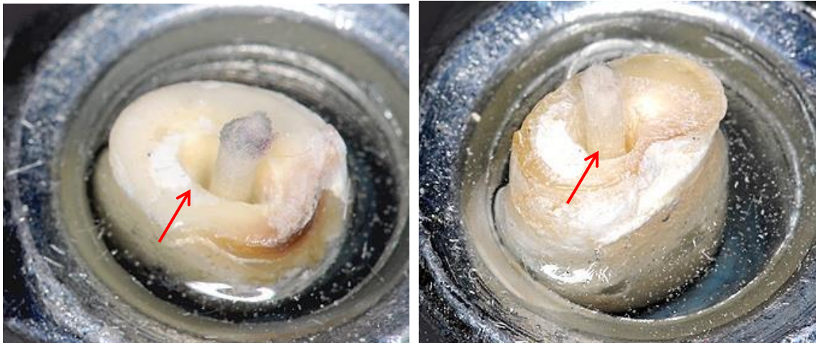
Figure 121. Tenons en fibre de verre sous compression axio-apicale. Iconographie Dr. LEMNADJLIA I - Pr. SID R
