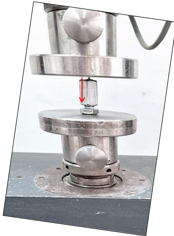
Figure 70. Tests en axio-apical sur Zwick/Roell Z 020.
