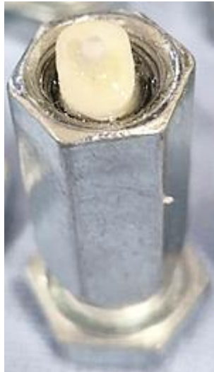
Figure 66 . Dent centrée dans l'éprouvette et noyée de résine Epoxy.
