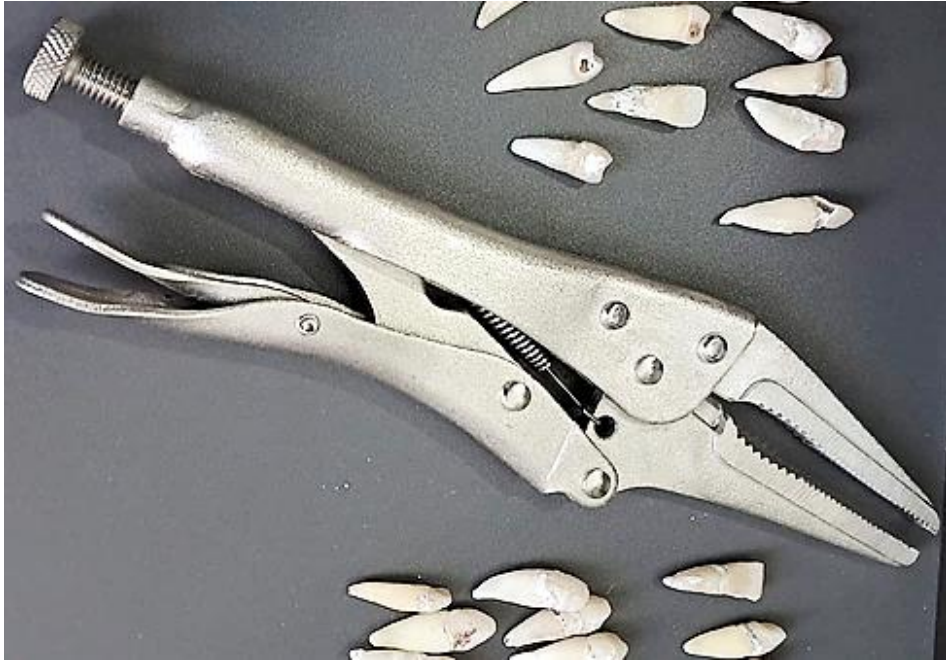
Figure 47. Pince Etau servant de support bloquant des dents lors du tronçonnage.
