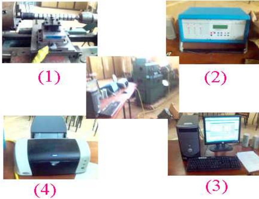
Fig. 2.11 : installation de détermination des composants de l'effort de coupe. (Laboratoire Mécanique univ .Guelma)
