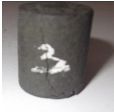
Figure 43 : exemple de rupture du cylindre
