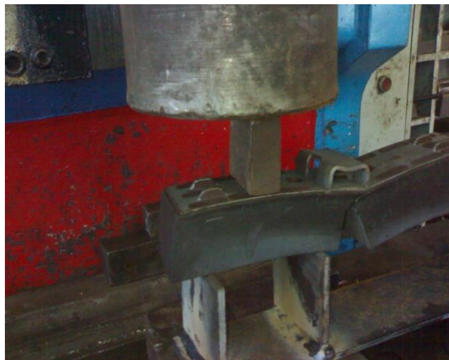
Figure 38 : essai de flexion de type 2
