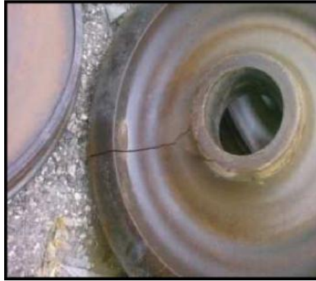
Figure 17 : toile fissurée (photo prise à l'AMF)
