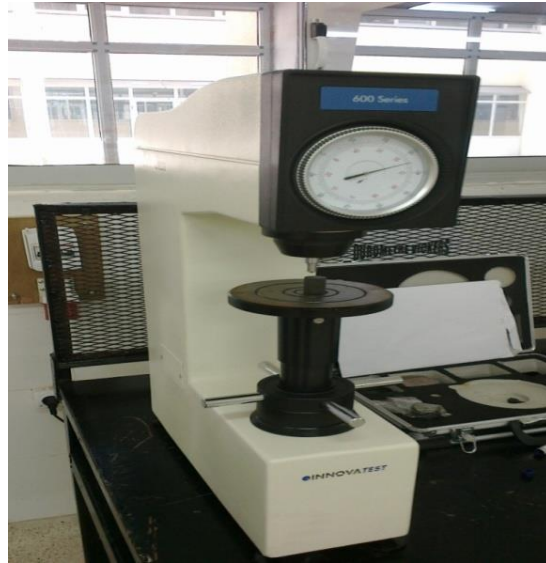
Figure 28 : appareil utilisé pour la mesure classique de la dureté
