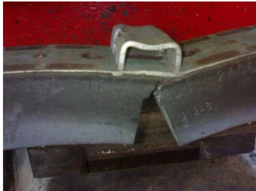
Figure 58 : résultat d'essai N° 1 de la flexion
