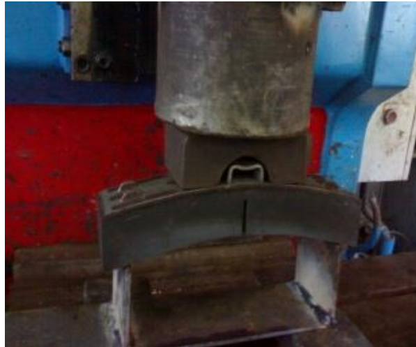
Figure 37 : Application de l'essai de flexion de type 1
