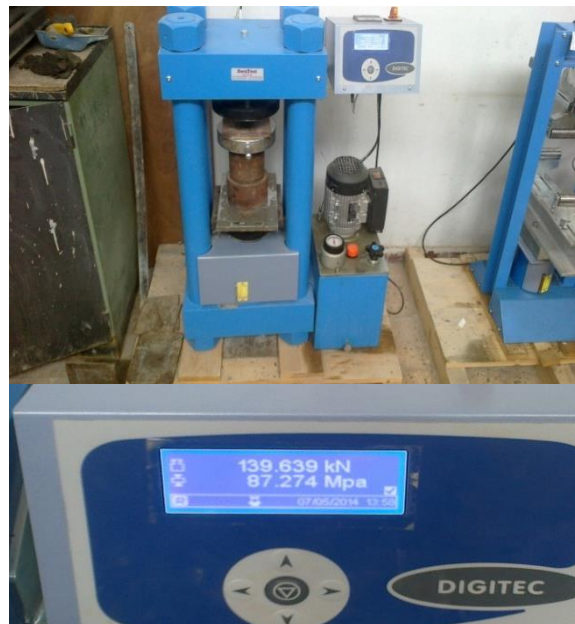
Figure 32 : dispositif utilisé en compression
