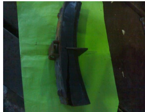
Fig. 57: assemblage (tôle-composite) décollé
