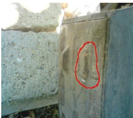
Figure 48 : dispositif de fixation endommagé Figure 49: semelles usées sur un seul coté
