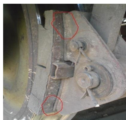
Figure 48 : dispositif de fixation endommagé Figure 49: semelles usées sur un seul coté
