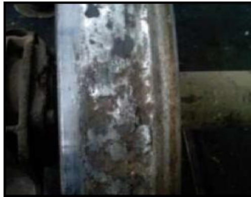
Figure 12: apport de métal sur la table de roulement (photo prise à l'AMF)
