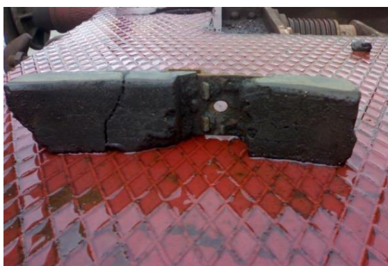
Figure 52 : décollage de la tôle au milieu
