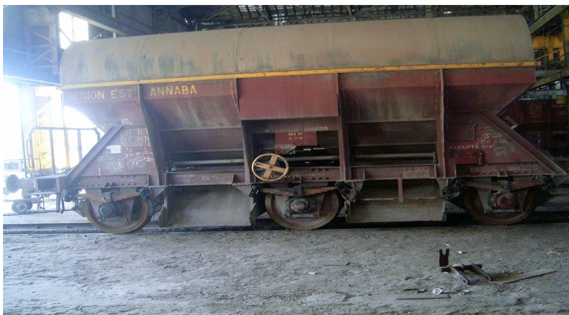
Figure 33: Exemple de wagon à essieux équipé de 8 sabots aux roues extrêmes
