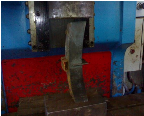
Figure 34 : essai de la résistance du sabot
