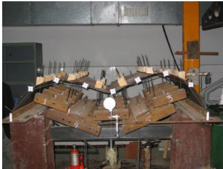
Fig.III-24 Etat final de la voûte avec renforcement
