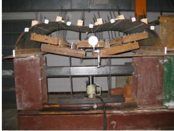
Fig.III-17 Etat final de la voûte sans renforcement
