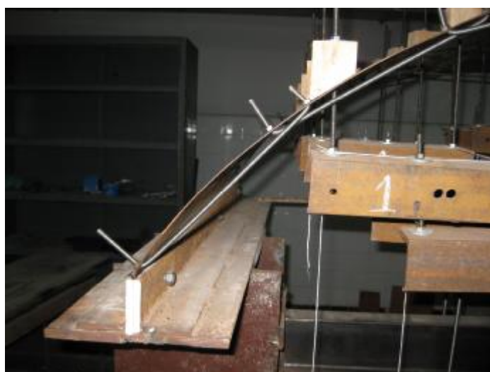
Fig. III-23 Vue sur les tirants de renforcement
