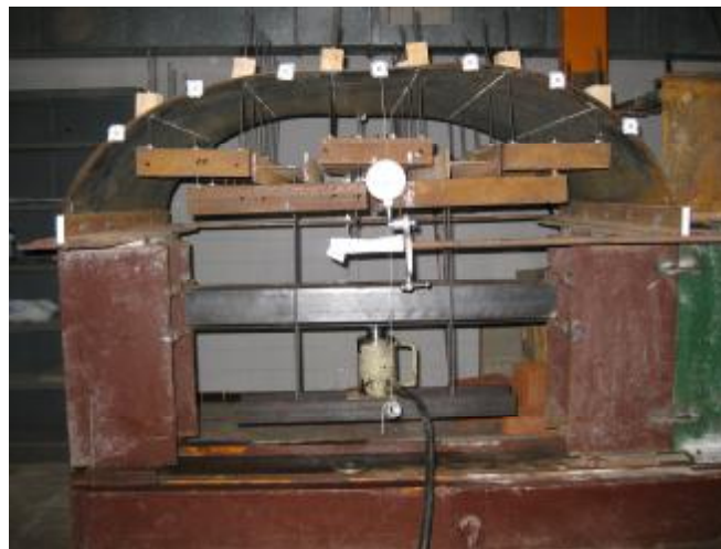
Fig.III-16 Etat initial de la voute sans renforcement
