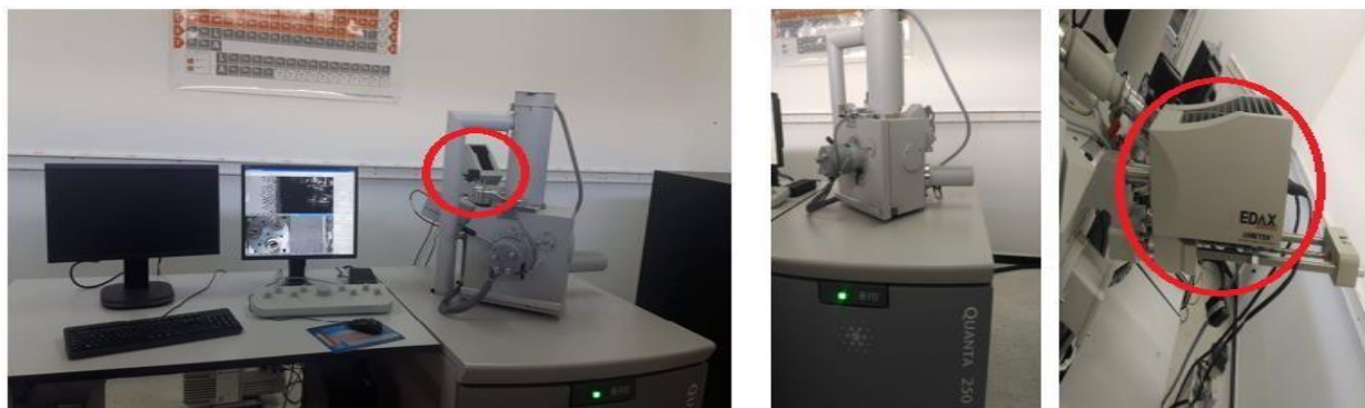
Figure 31: Microscope électronique à balayage (MEB) de marque QUANTA 250® couplé à l'EDS de marque AMETEK®.
