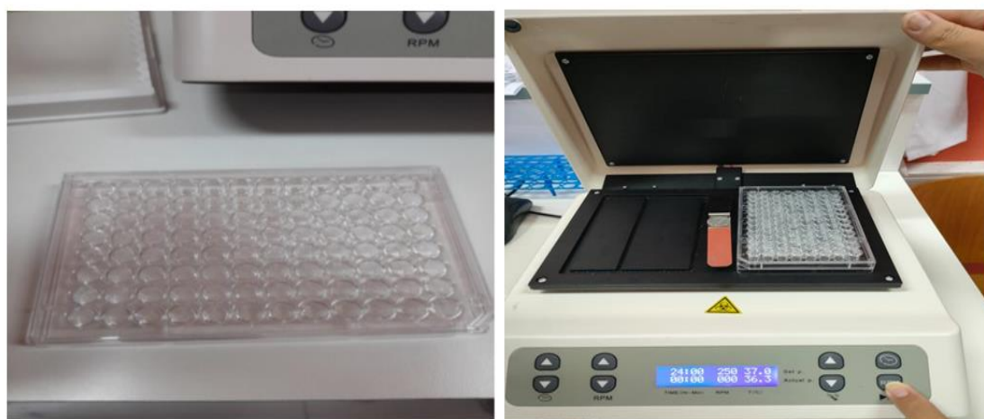
Figure 131: Microplaque de détermination de la CMI et agitation pour homogénéisation des échantillons.
