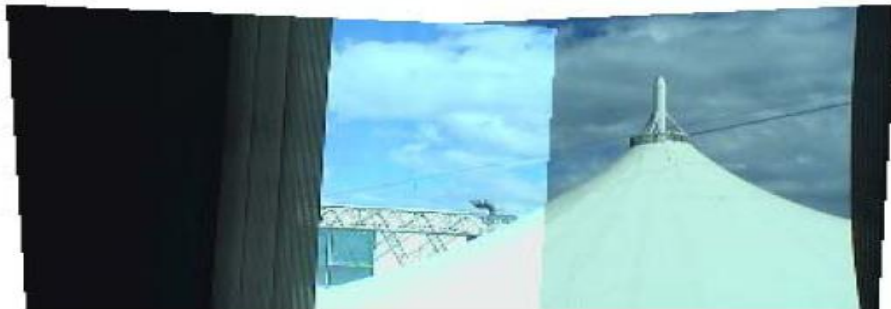
Figure 3.8: Gain automatique, l'extérieur est visible mais présence de couture
