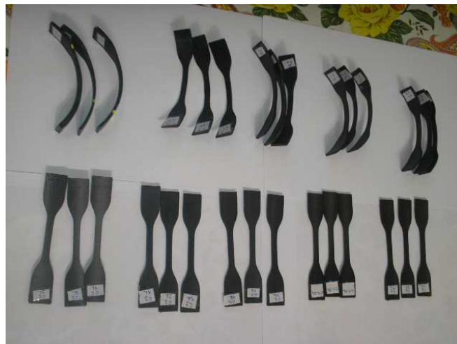
Figure III.6 : Eprouvettes de traction découpées dans les deux directions ; longitudinale et transversale.
