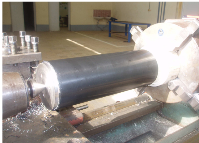
Figure II.9 : feuille extraite du HDPE-80 après tournage.
