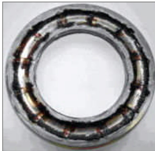
Figure I.22: Faux effet Brinell sur une bague de butée.
