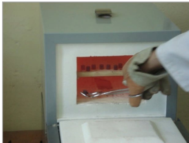
Figure III.15: Vue montrant l'enlèvement des pièces du four pour immersion dans un bain d'huile.
