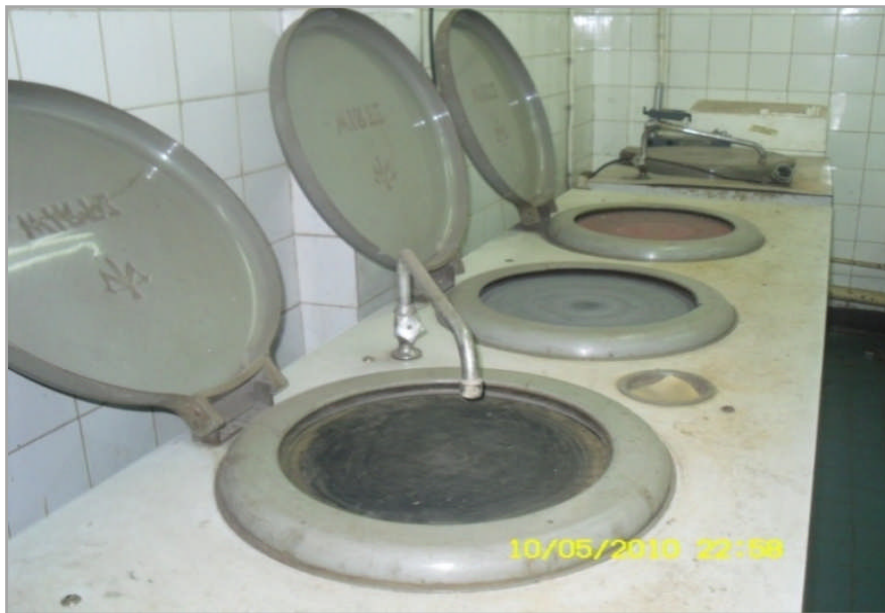
Figure III.18: Polisseuse monoplateau utilisée lors de la préparation des éprouvettes.
