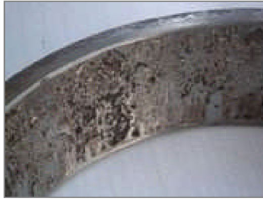
Figure I.18 : Ecaillage sévère sur une bague extérieure de roulement.
