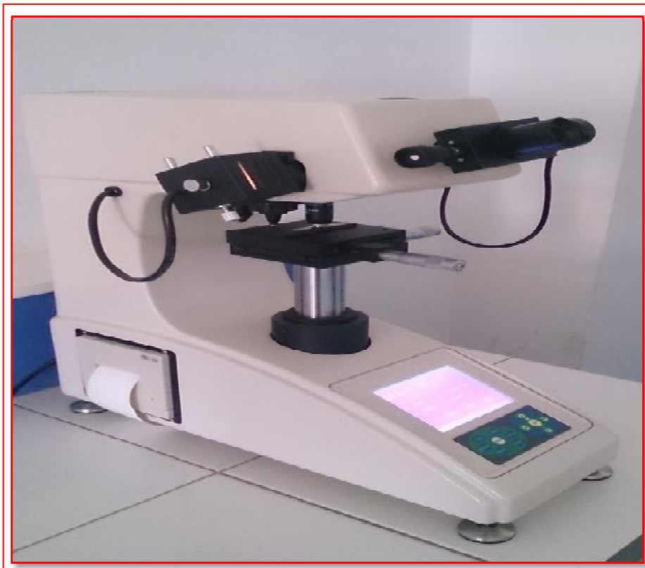
Figure II.12 .Microduromètre Wolprt Wilson instruments
