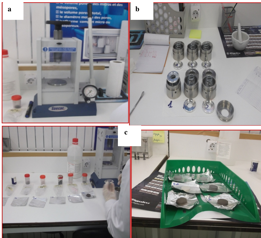
Figure II.4. Préparation d'un échantillon en poudre des Flux et des laitiers (a : Presse, b : Mortier , c : Echantillons sous forme de pastille)
