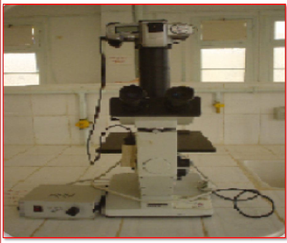
Figure II.10. Microscope optique de type (Olympus BX J1M).
