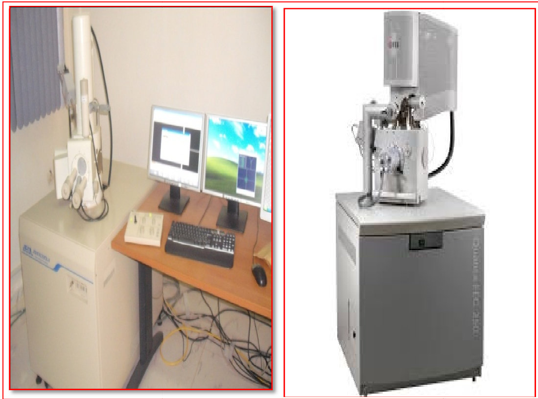
Figure II.11. Microscope électronique à balayage (MEB et EDAX).
