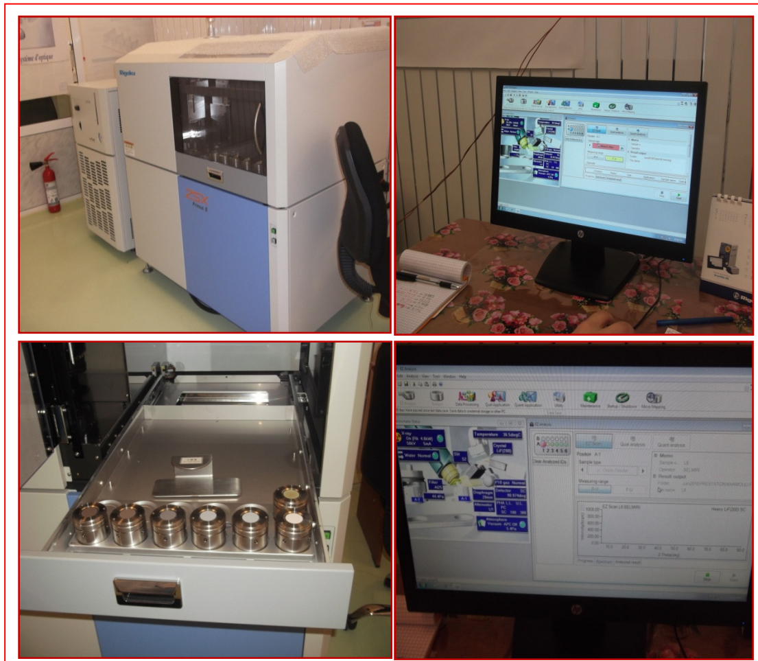
Figure II.5. Appareil de spectrométrie de fluorescence des rayons X (FRX) de type Rigaku ZSX Primus II.
