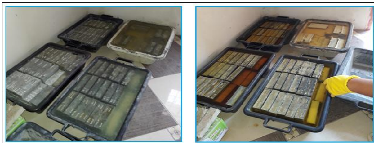
Figure 64: Des bio-composites cimentaires renforcées par des fibres d'Alfa et de Diss traitées (bouillis) et non traitées immergés dans l'eau de mer et dans NaOH 5%
