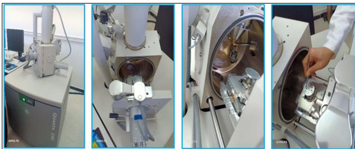
Figure 26: Mise en place des échantillons sur le platine porte-objet du MEB
