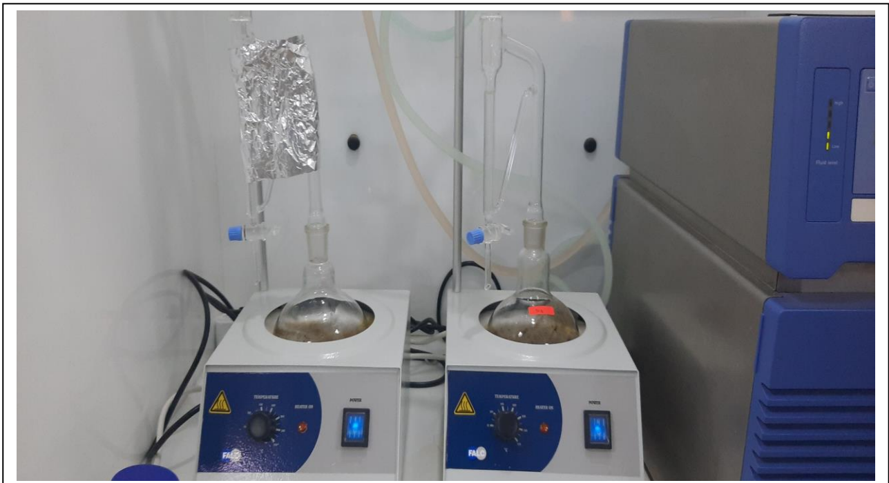
Figure A13 : Schéma du protocole de distillation et du montage de Clevenger utilisé pour l'extraction des huiles essentielles de P. hierichuntica
